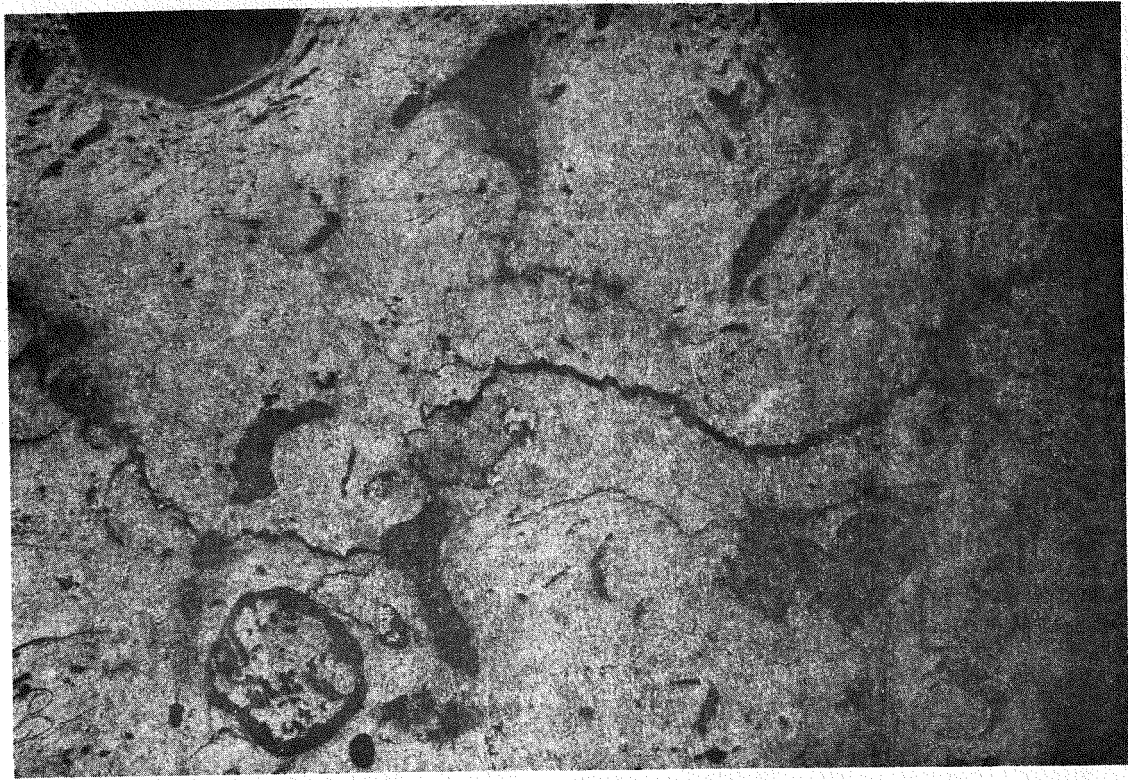
Abb. 23: Bereich in der Nähe der Rißspitze (Vergrößerung: 50 x)
