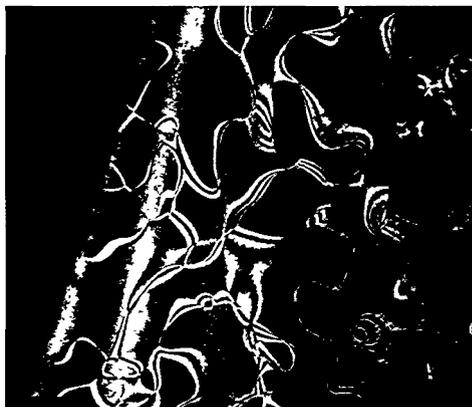
Parois d'antiphase dans  $Fe_3Al$  observées en microscopie électronique en transmission (image de franges grossissement: 100000)
