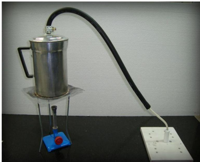
FIGURA 12 - Montagem da fonte de vapor para realização de lesão térmica nos animais.
