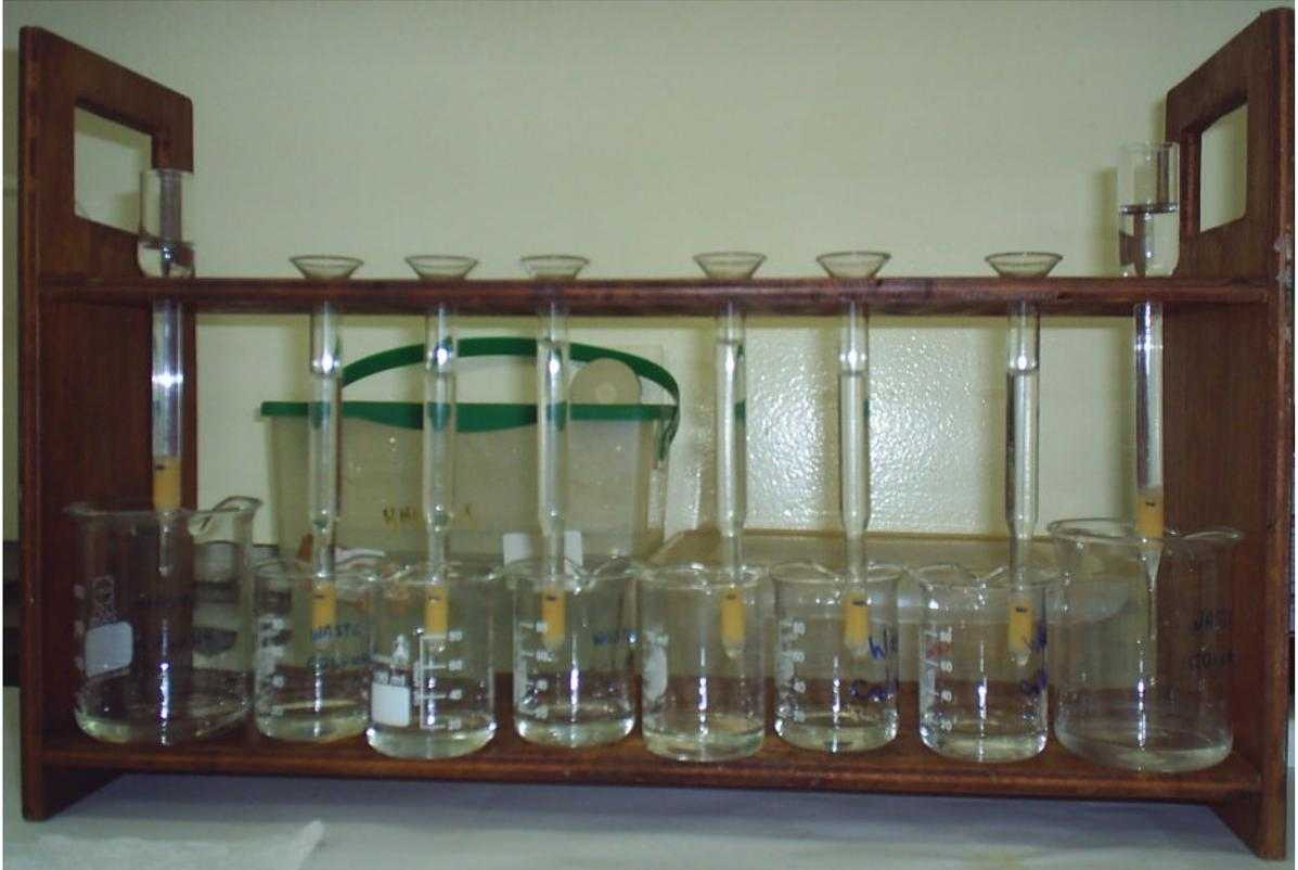
FIGURA 8 – Técnica de separação de troca iônica, para mercúrio inorgânico e orgânico, realizada nas amostras
