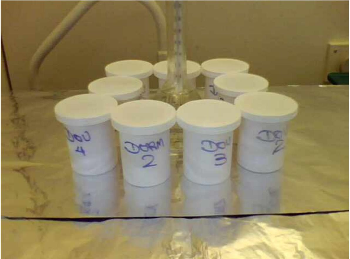
FIGURA 11 – Recipiente de teflon<sup>®</sup> utilizado na preparação de amostras para a técnica IDMS
