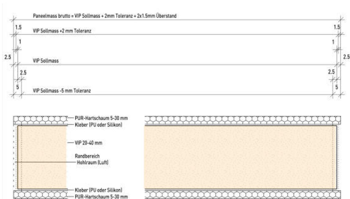
Abbildung 6: Schnitt durch ein VIP mit Kaschierung. Grafik: FHNW
