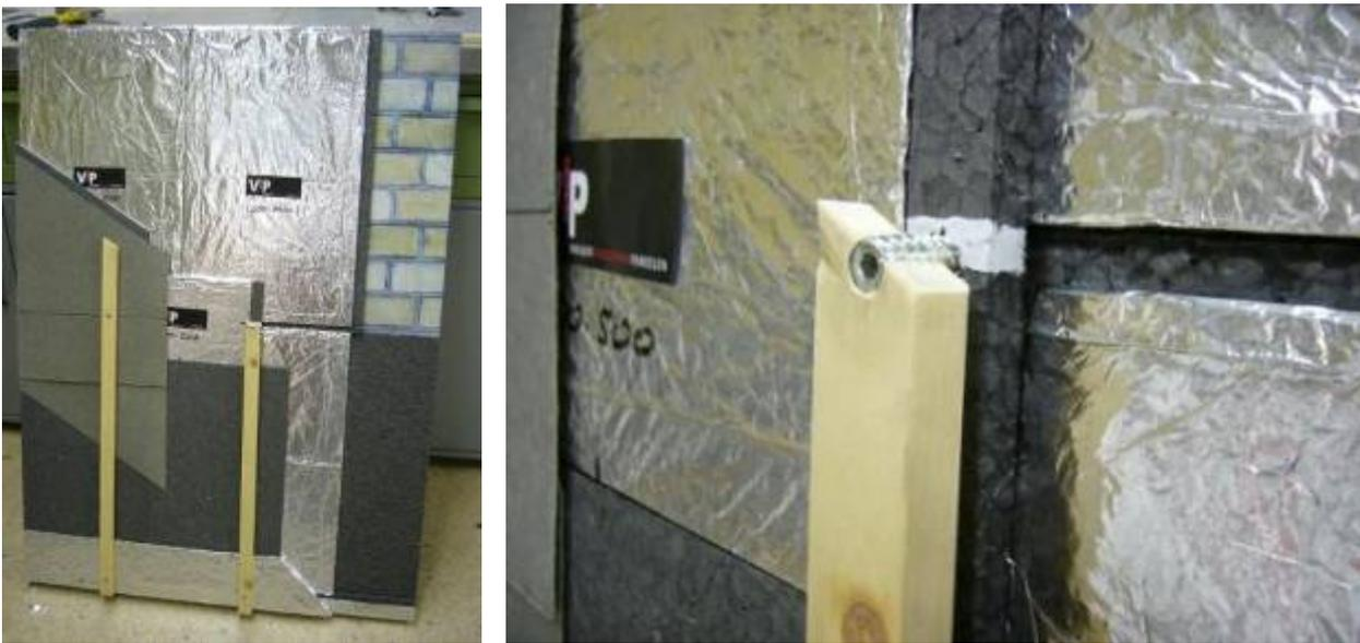
**Abbildung 18: Arbeitsmodell des Distanzschraubensystems im Massstab 1:2. Die horizontalen EPS-Fugen werden hier zusätzlich mit einer zweiten VIP-Lage abgedeckt.** Bilder: swisspor
