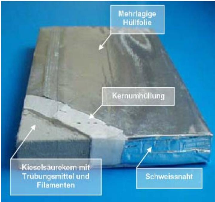
Abbildung 3: Aufbau eines VIP. Bild: va-Q-tec
