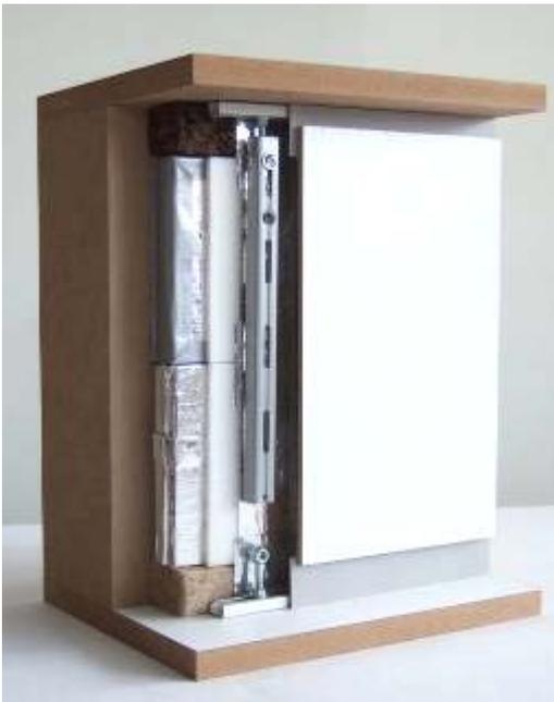
Abbildung 36: Arbeitsmodell des Systems für Innendämmung mit VIP. Foto: FHNW
