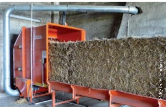
*Transportband und Ballenöffner am Strohheizwerk*
