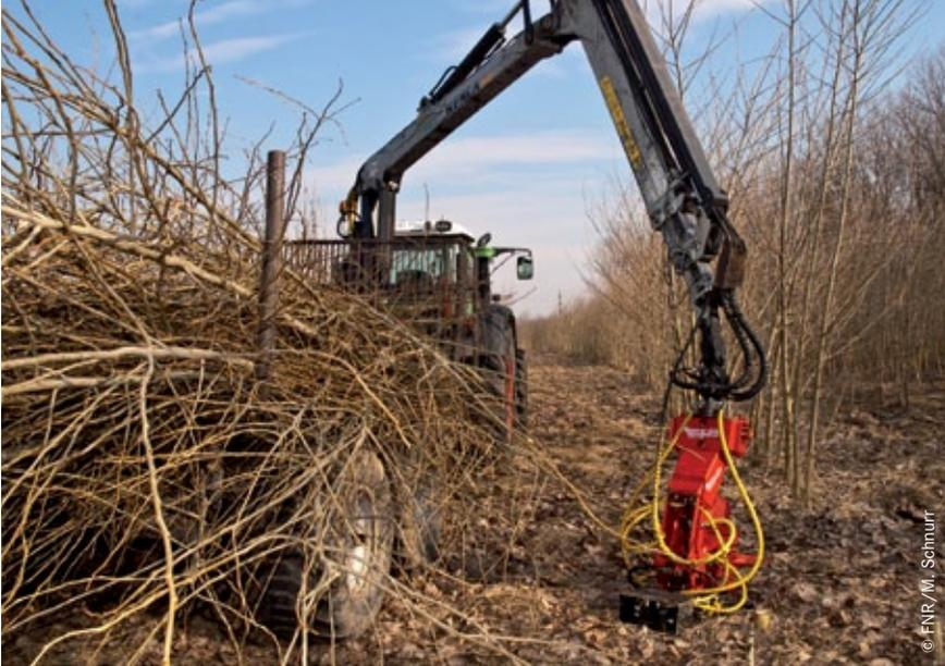
*Energieholzernte mit Fäller-Bündler-Aggregat*
