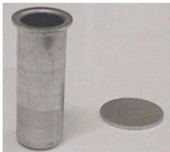
**Figura 1.** Forma de la cápsula y tapa de aluminio.
