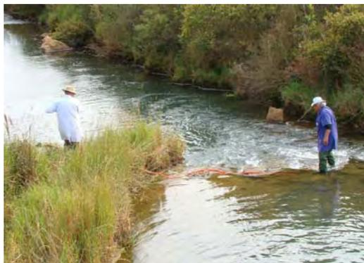
**Figura 2.** Preparación e inyección del trazador radiactivo con el orgánico.
