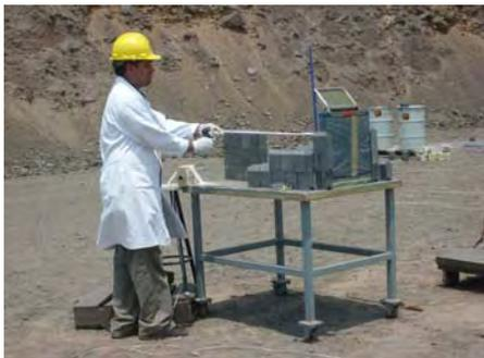
**Figura 3.** Utilización de telepinzas para ganar distancia.
