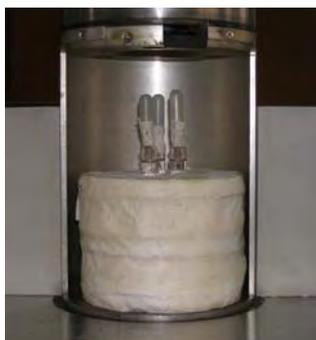
**Figura 3:** Posición de los dosímetros en aire en Gammacell 220 Excel.
