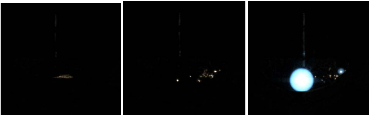
Abb. 16: Beginn des Übergangs zu Funkenregen nach einem Schlagvorgang - zwischen unlegiertem Stahl, W = 71 \text{ Nm} , 8,0 Vol.-% Acetylen/Luft-Gemisch: Erzeugung der Partikel durch Abtrennvorgang, Beginn der Oxidation, - Zündung des Gemisches durch mehrere Partikel, Beginn der Überlagerung der Wärmefelder
