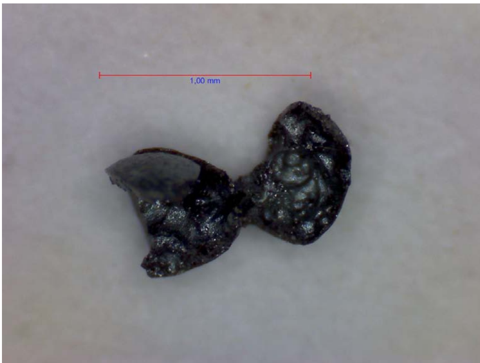
Abb. 11: Zum Teil geschmolzenes, nicht oxidiertes großes Stahlpartikel nach einem Schlagvorgang mit W = 190 Nm in 100 % Helium
