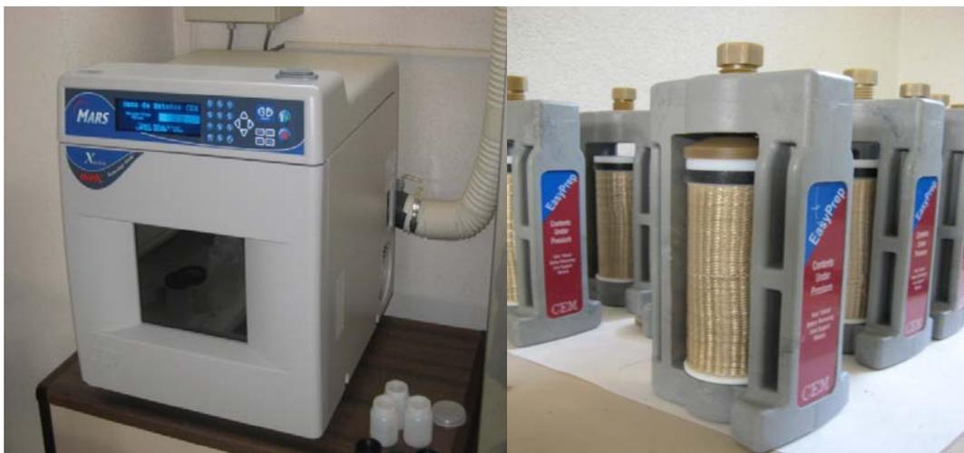
**Figuras 13 y 14:** Microondas MARS (Izq.) y vasos de digestión preparados para introducirlos al microondas (Fuente: Elaboración propia)
