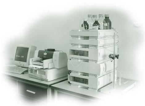
Figura 5. Cromatógrafo del Líquidos de Alta Eficiencia (HPLC).
