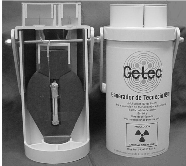
Figura 7. Generador de  $^{99}\text{Mo} / ^{99\text{m}}\text{Tc}$  producido en el ININ
