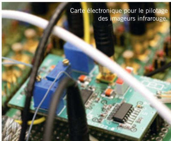
Carte électronique pour le pilotage des imageurs infrarouge.
