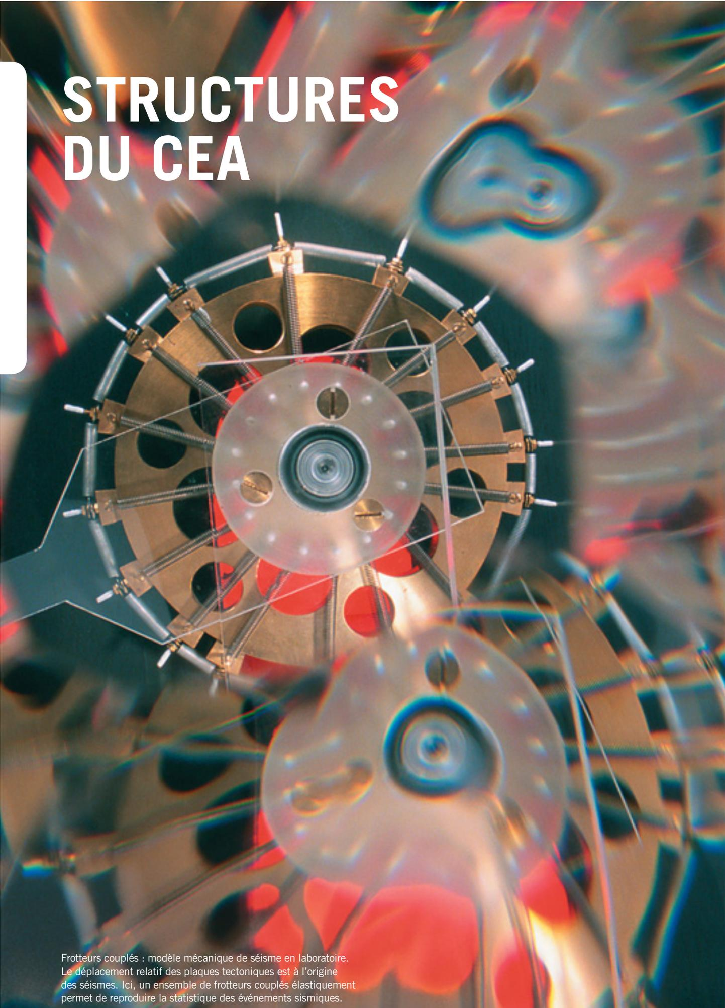
Frotteurs couplés : modèle mécanique de séisme en laboratoire.
