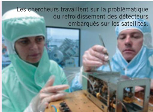
Les chercheurs travaillent sur la problématique du refroidissement des détecteurs embarqués sur les satellites.
