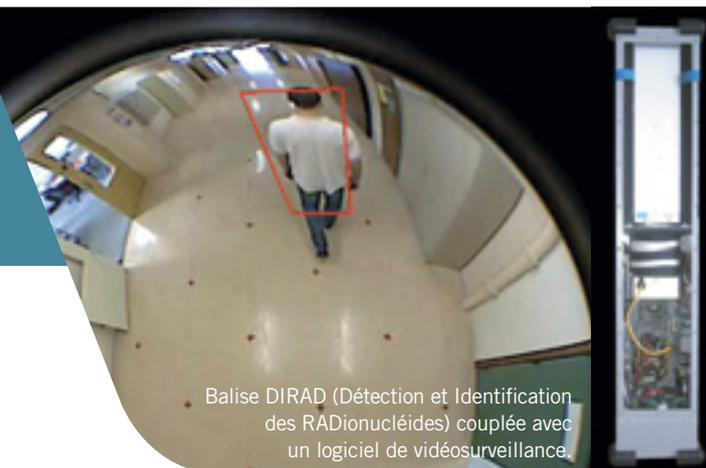
Balise DIRAD (Détection et Identification des RADionucléides) couplée avec un logiciel de vidéosurveillance.
