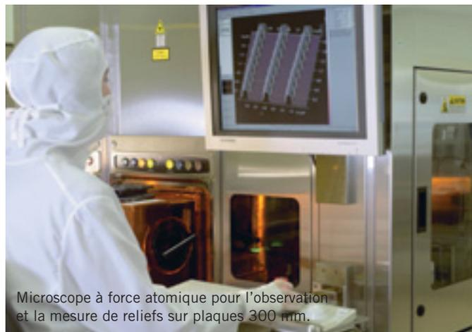
Microscope à force atomique pour l'observation et la mesure de reliefs sur plaques 300 mm.
