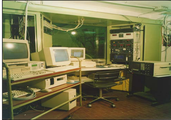
Figura 4. Quadro di controllo e acquisizione dati della sala prova del motore a gas naturale
