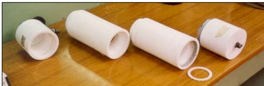
Figura 9. Moduli in PTFE porta-PUF per il campionamento delle sostanze semivolatili
