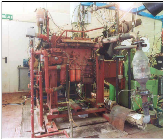
Figura 2. Motore IVECO 8469.21 alimentato a gas naturale
