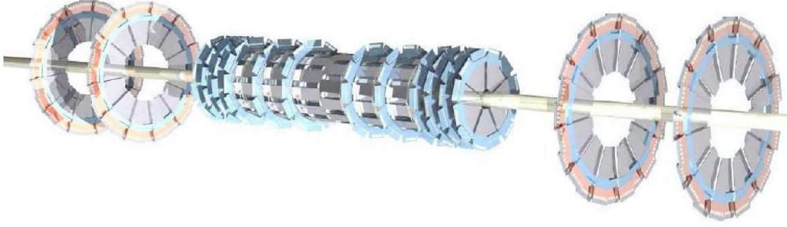
FIG. 3.3.4 — Représentation en 3D du SMT : barillets, disques F (internes) et disques H (externes), composés de 1 ou 2 couches de semi-conducteurs simple ou double faces
