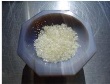
Figura 5.7 Polímero obtenido por la polimerización iniciada térmicamente del ASEA en atmósfera con O<sub>2</sub>
