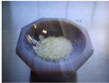
Figura 5.24 Producto obtenido por la irradiación de la mezcla AS-ASEA 50/50 en masa a 440 kGy en atmósfera con O<sub>2</sub>
