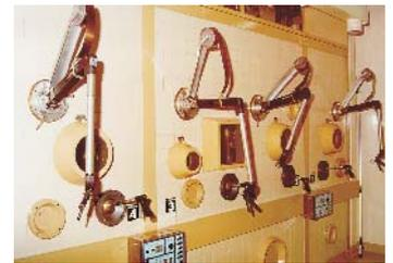
Proyecto LFR - Laboratorio de Facilidades Radioquímicas: Celdas con telemanipuladores
