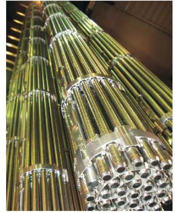
Área Energía Nuclear: Elementos combustibles tipo PHWR para la Central Nuclear Atucha I.
