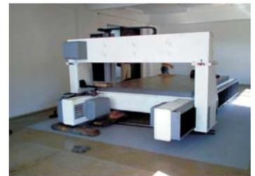
Proyecto Antena Radar de Apertura Sintética: Fresadora de producción (Figura 5) Centro Atómico Constituyentes
