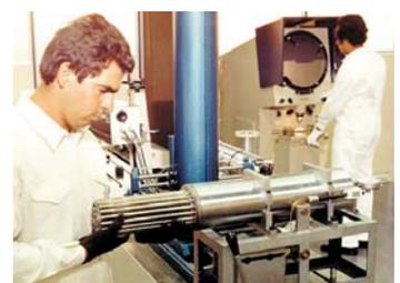
Detalle de la fabricación de elementos combustibles tipo CANDU en CONUAR S.A. en su planta de Ezeiza Pcia de Buenos Aires
