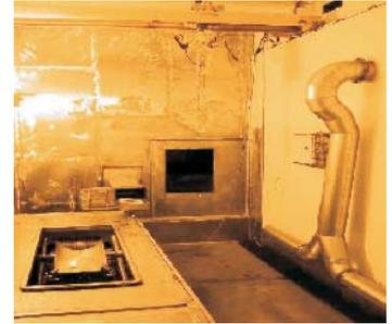
Proyecto LAPEP -Laboratorio de Ensayos Pos Irradiación: Celda de recepción de elementos combustibles gastados
