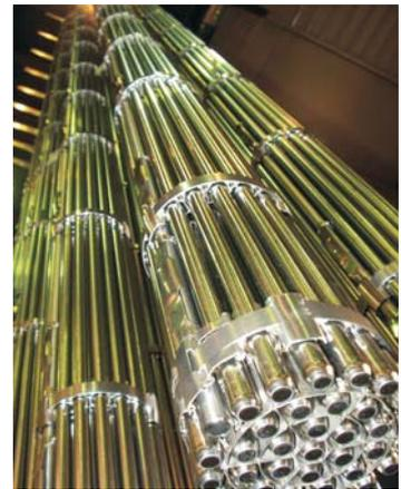
Elementos combustibles tipo PHWR para la Central Nuclear Atucha I fabricados por CONUAR S.A. en su planta de Ezeiza Pcia de Buenos Aires
