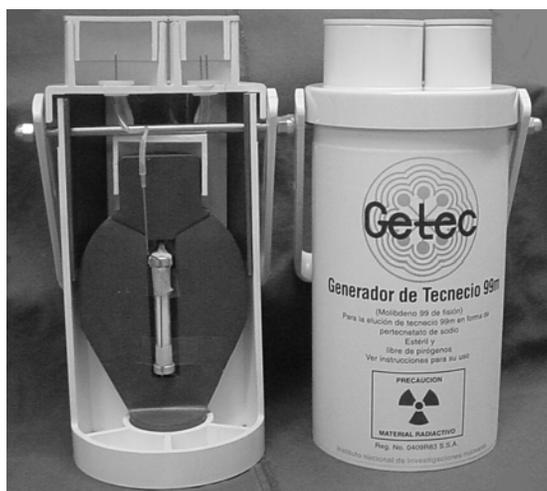
Figura 7. Generador de  $^{99}\text{Mo}/^{99m}\text{Tc}$  producido en México
