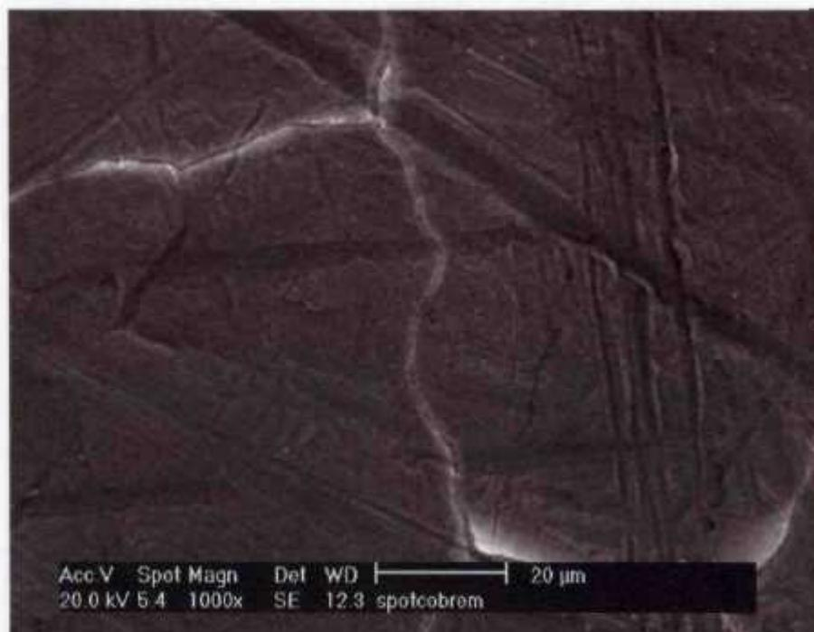
Figura 5.13 – Imagem obtida por microscopia eletrônica de varredura do fundo da lingoteira, com depósito de filme metálico oriundo da fusão de cavacos prensados de Zircaloy.
