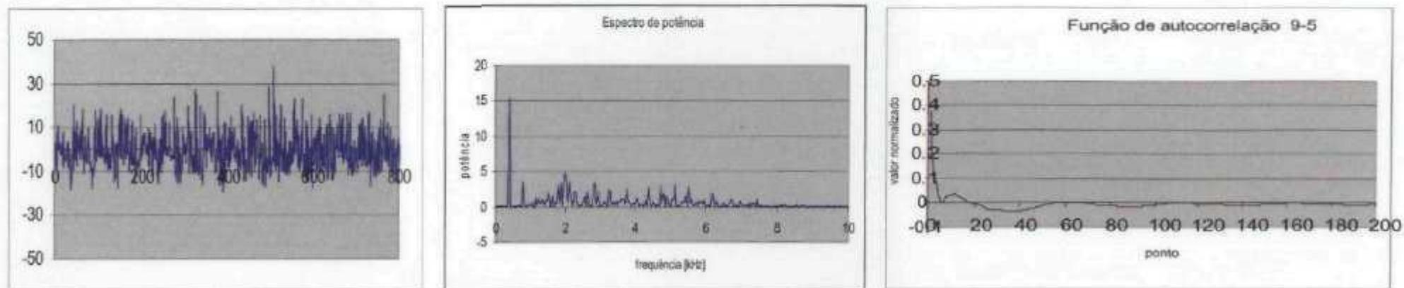
Figura 5.22.5 – Quinto trecho do sinal de uma gota. Arco elétrico intensamente perturbado pelo acúmulo de metal líquido na extremidade do eletrodo.
