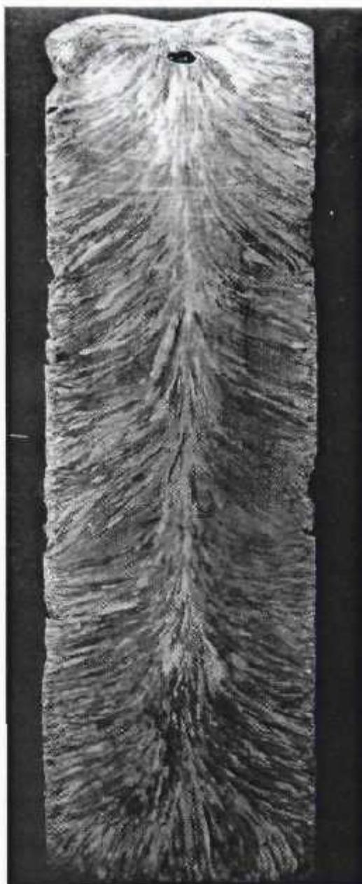
*Figura 3.7 – Macrografia da solidificação de um lingote VAR <sup>[2]</sup>.*
