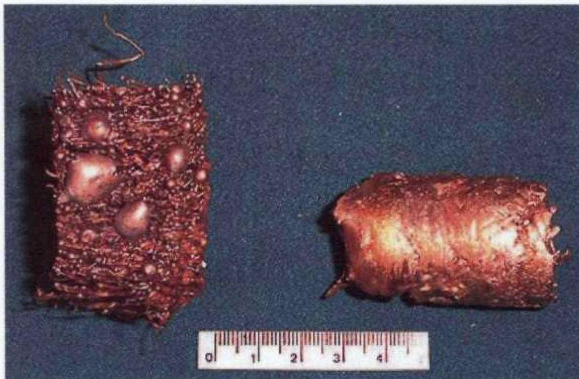
*Figura 5.7 - Fotografia da extremidade do eletrodo e do lingote obtido na fusão 3.*
