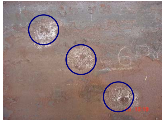
Foto 4. Acercamiento a una de las discontinuidades para observar la morfología.
