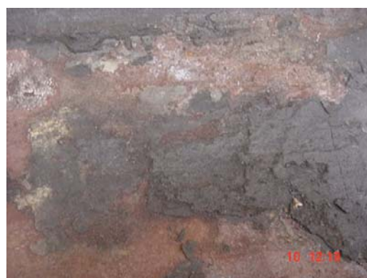
Foto 2. Capa de sólidos oscura y gruesa adherida a la superficie.
