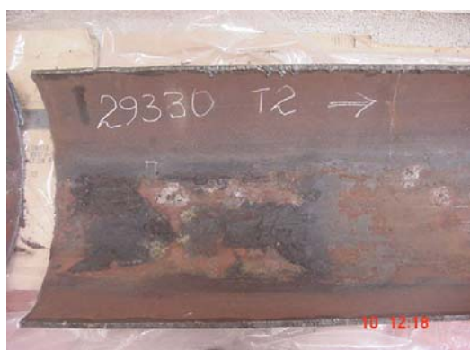
Foto 1. Sección a analizar, se observa la capa de sólidos adherida a la pared del tubo.
