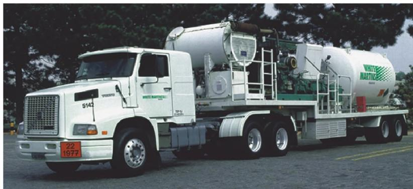
Figura 9. Sistema móvel de bombeamento de nitrogênio (6.000m<sup>3</sup>/h, 350kgf/cm<sup>2</sup>G)
