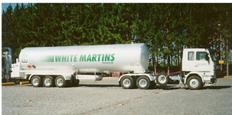
Figura 8. Carreta para transporte de nitrogênio ( $24.000\text{m}^3 @ 21^{\circ}\text{C}$  e 1atm)
