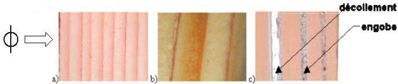
Figure 33 : Comparaison des multicouches obtenues par thermocompression et par encapsulage.
