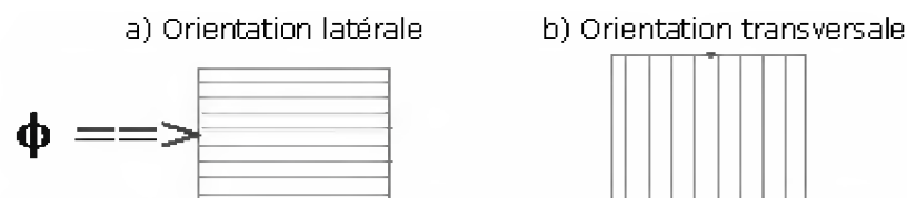
Figure 34 : Etude de l'anisotropie : illustration de l'orientation des échantillons par rapport à l'impulsion laser
