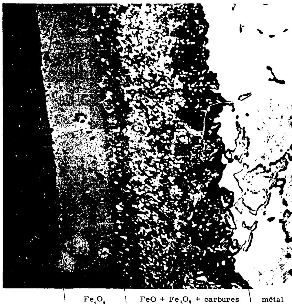
Différentes couches observées dans l'oxyde formé au-dessus de 570°. Influence de la pression et de la composition du métal : 2ème partie II-B-1°.
