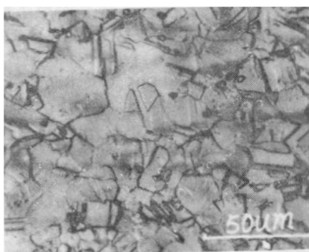
图 6-3 固溶+敏化 D 未辐照 650 °C
