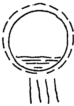
Figure 7 - Cavité stable dans le sel. Pas d'effondrement de la voûte.
