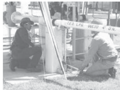
Figura 2. Midiendo reacciones a compresión.
