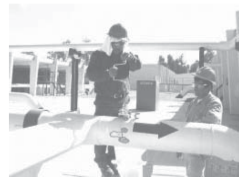
Figura 10. Barrenando una roseta de deformímetros.
