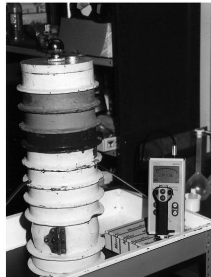
*Castillo de plomo utilizado como blindaje para medición de gamma emisores.*
