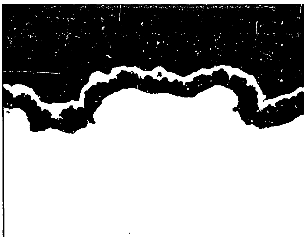
Fig. 22 - Coupe des couches d'oxyde formées sur l'alliage Mg-Mn (sous forme de tôle) après un traitement de 4600 heures à 550°C dans le gaz carbonique pur sous 60 bars, comportant 330 cycles thermiques courts (24 heures, en haut) ou 55 cycles thermiques longs (96 heures, en bas) entre 550 et 100°C
