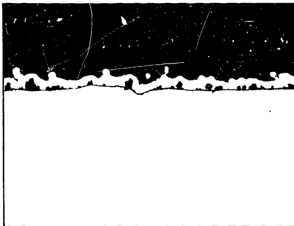
Fig. 9 - Coupe de la couche d'oxyde formée sur l'alliage Mg-Mn (sous forme de tôle) après exposition de 6 500 heures à 500°C dans le gaz carbonique ordinaire sous 25 bars (X 480)
