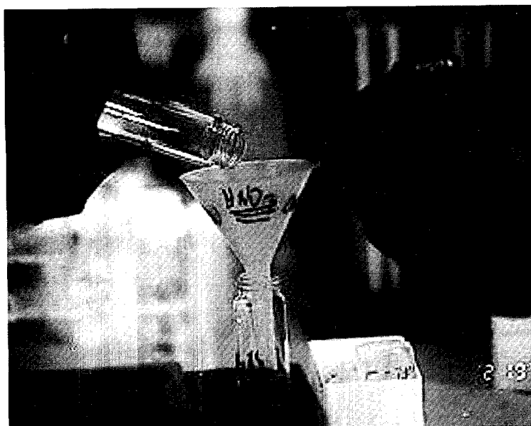
Figura IV-18. Lavado de un reactor usado en los ensayos de lixiviación con \text{HNO}_3 1N para su posterior análisis.
