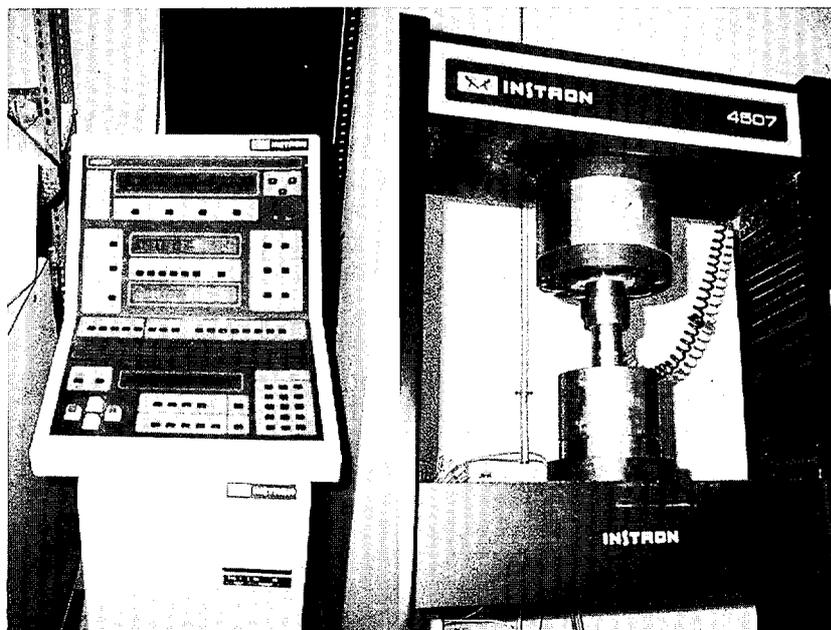
Figura 5.1. La imagen derecha muestra la prensa Instron 4807 durante una de las compactaciones. La imagen izquierda muestra la consola de control de la misma.
