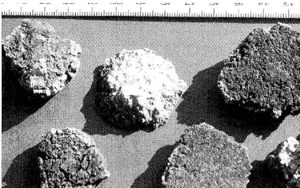
Figura 7.22. Capa superficial de hematites en muestras de bentonita en contacto con las probetas metálicas.
