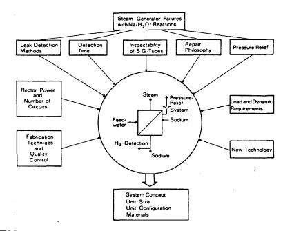
$FIG,\,2$  . CRITERIA FOR THE DESIGN OF STEAM GENERATOR SYSTEMS
