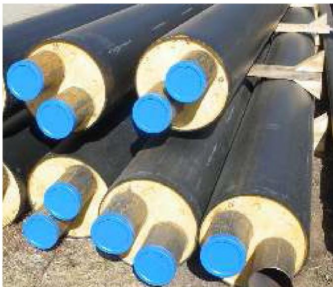
Figur 3-4, Twin rør på lager
